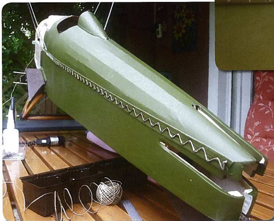
Die Paketschnur wird mit Sekundenkleber fixiert und letztendlich überlackiert
