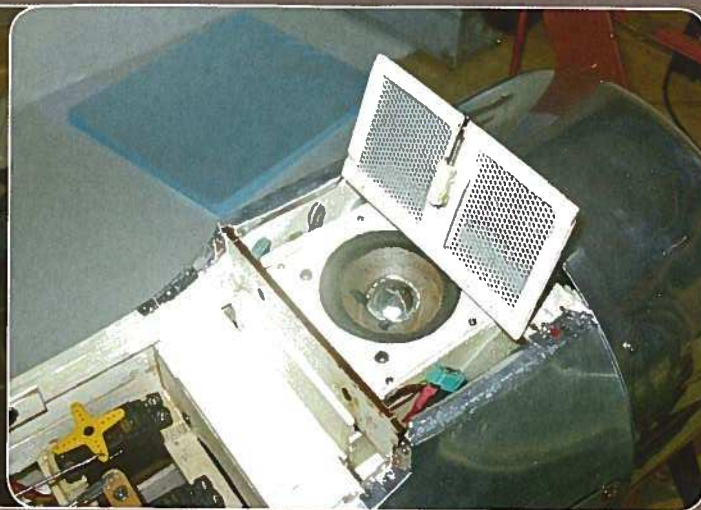
Hier sieht man den Einbauort der Lautsprecher in der »Sopwith«. Der rückwärts gerichtete Lautsprecher lässt sich vor den im Bild sichtbaren Servos erahnen
