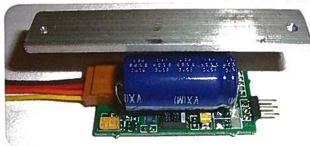
Der 50-W-Verstärker von Benedini, um dem Sound den nötigen Nachdruck zu verleihen
