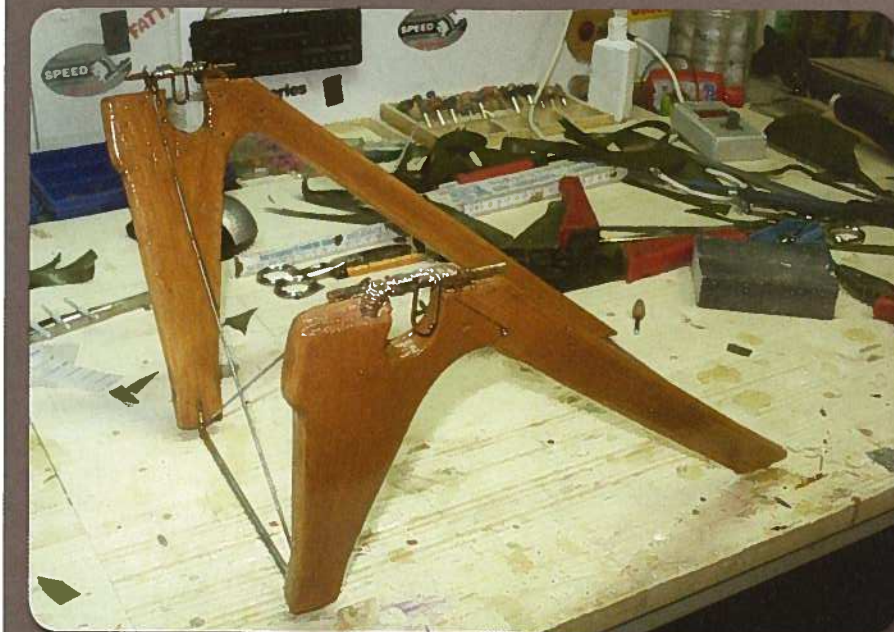
Die Holzstreben sehen massiver aus, als sie wirklich sind. Sie bestehen aus Balsaholzzuschnitten, die nachträglich um die Federstahldrähte des Serien-Fahrwerks laminiert wurden. Das Drahtfahrwerk wird zuvor aus vorgebogenen Bügeln zusammengelötet. Die Achsführungen und die Haltehaken für die Bungees werden mit Kupferdraht um den Fahrwerksdraht gewickelt und anschließend ebenfalls satt verlötet. Das Ganze wird mit den diagonalen Verspannungen in Form gebracht
