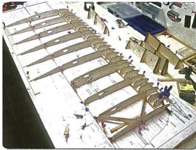
Der Aufbau des Modells erfolgt in klassischer Weise direkt auf dem 1:1-Plan
