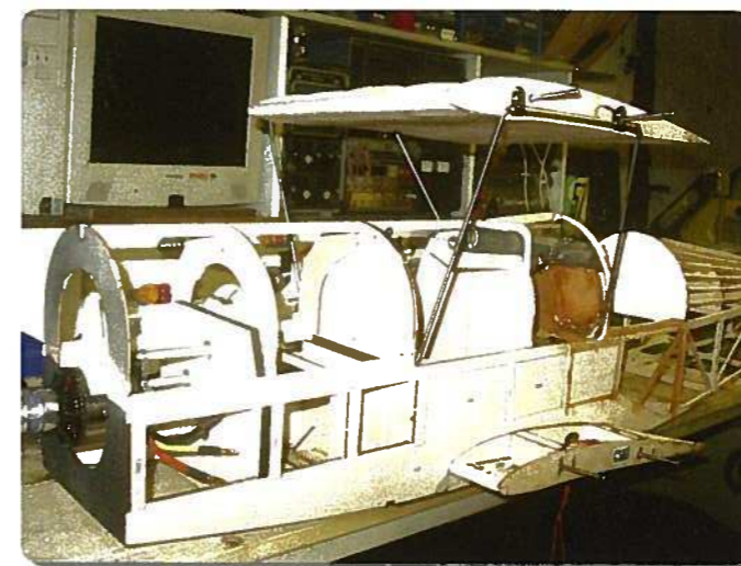
Die Stahlstifte sind in den Flächenmittelstücken durch mehrere Sperrholzrippen geführt und verkastet. Die Verkastung ist mit Epoxi ausgegossen. Anstelle des vorgesehenen Spants wurde ein schmaler Rahmen eingebaut, der später die Beplankung trägt. Das Instrumentenbrett wurde, wie beim Vorbild, schräg gestellt und in Form und Radius an die Kontur des Rumpfs angepasst. Die Metallkante am Ausschnitt des horizontalen Holzteils ist aus selbstklebender Alufolie
