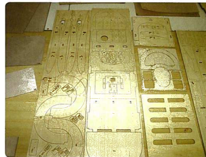
Der Baukasteninhalt ist perfekt verpackt und bringt eine Vielzahl von gelaserten Formteilen und Leisten hervor. Dieses Bild zeigt Sperrholzteile für den Rumpf und das Beplankungsmaterial aus Furnier
