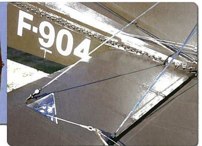
Ein Blick auf das HLW mit seinen Spann- und Steuerseilen
