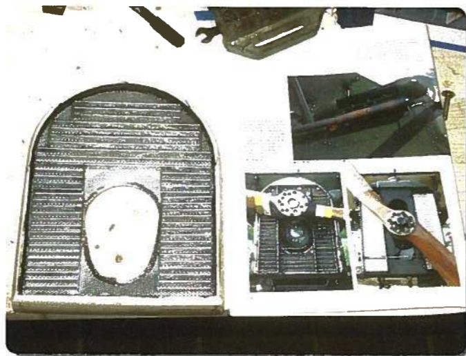
Der Kühler der »SE5« ist schon fast ein eigener Bausatz. Der Rahmen besteht aus einem gelaserten Balsa-Laminat. Die Kühlerjalousie ist ein Puzzle aus Sperrholzteilen. Ich bin an dieser Stelle von der Bauanleitung abgewichen, da wegen des elektrischen Antriebs hier die vorgeschlagene horizontale Teilung der Motorhaube nicht nötig war. Das Foto zeigt sehr schön den Unterschied zwischen der Ausführung mit dem Hispano- und dem Wolseley-Motor. Beide Fotos zeigen die »F904«
