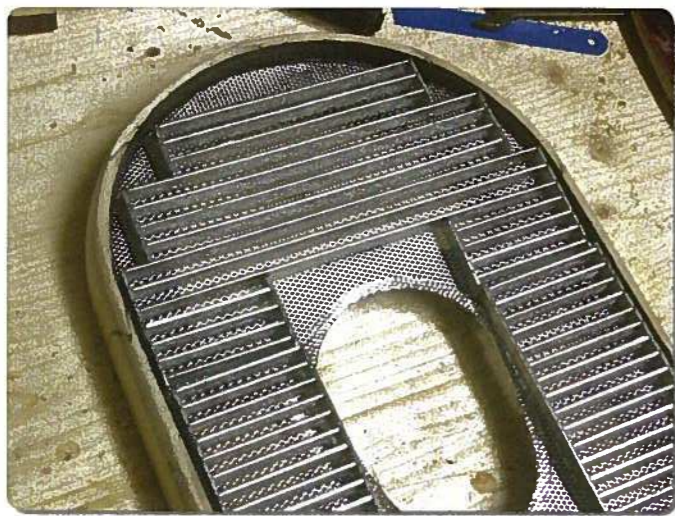
Der Kühler der »SE5« ist schon fast ein eigener Bausatz. Der Rahmen besteht aus einem gelaserten Balsa-Laminat. Die Kühlerjalousie ist ein Puzzle aus Sperrholzteilen. Ich bin an dieser Stelle von der Bauanleitung abgewichen, da wegen des elektrischen Antriebs hier die vorgeschlagene horizontale Teilung der Motorhaube nicht nötig war. Das Foto zeigt sehr schön den Unterschied zwischen der Ausführung mit dem Hispano- und dem Wolseley-Motor. Beide Fotos zeigen die »F904«
